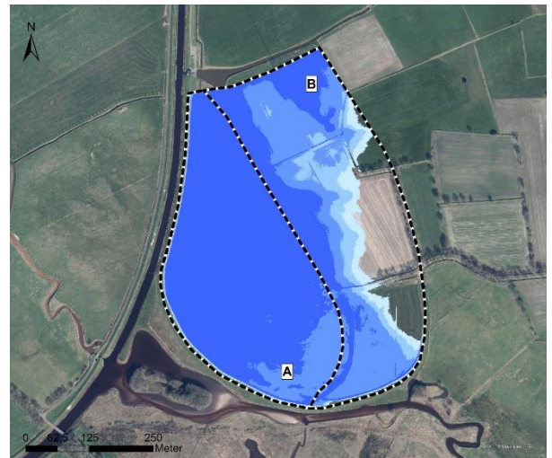
Überstaute Flächen bei Einstau auf 0,0 m NHN 0,4 m NHN 0,7 m NHN 1,0 m NHN
